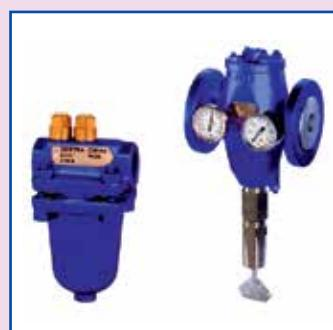
Oransal kontrollü CW PN 16, DN 25-100 tipi soğutma suyu kontrol vanası yardımcı enerji kullanmadan çalışır. Soğutma suyu miktarını geri besleme sıcaklığıyla orantılı olarak ayarlayan kontrol vanalardır.
